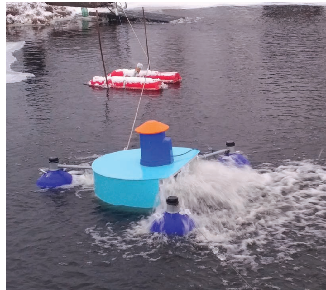
Гидромонитор для размыва донных отложений в рыбоводных прудах
