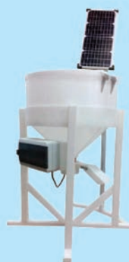
Программируемая автономная кормушка с солнечными батареями обеспечивает распределение корма на расстояние от 1 до 15 м
